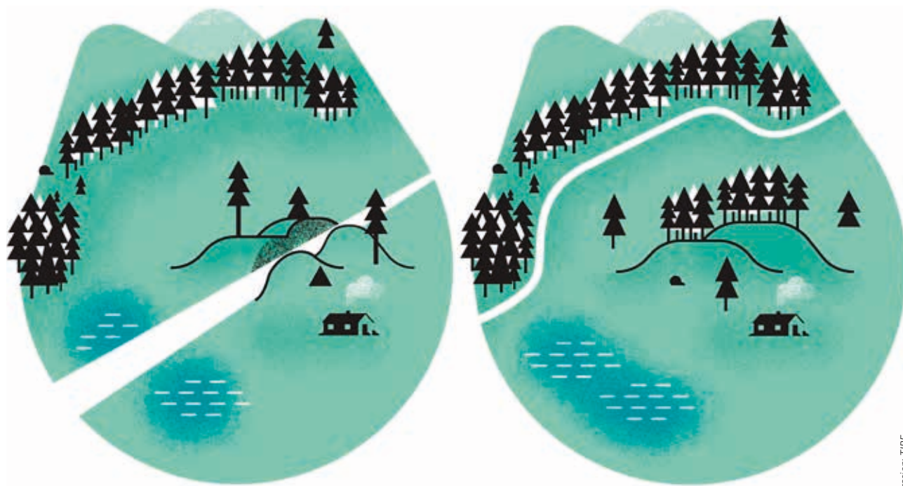
Stier og turveier bør følge terrenget. En trase tvers over myra med skjæring gjennom haugen, vil bli et markert og skjemmende inngrep i landskapet, spesielt om det nyttes materialer som skiller seg ut. Det er bedre å legge traseen i utkanten av myra, langs skogkanten
