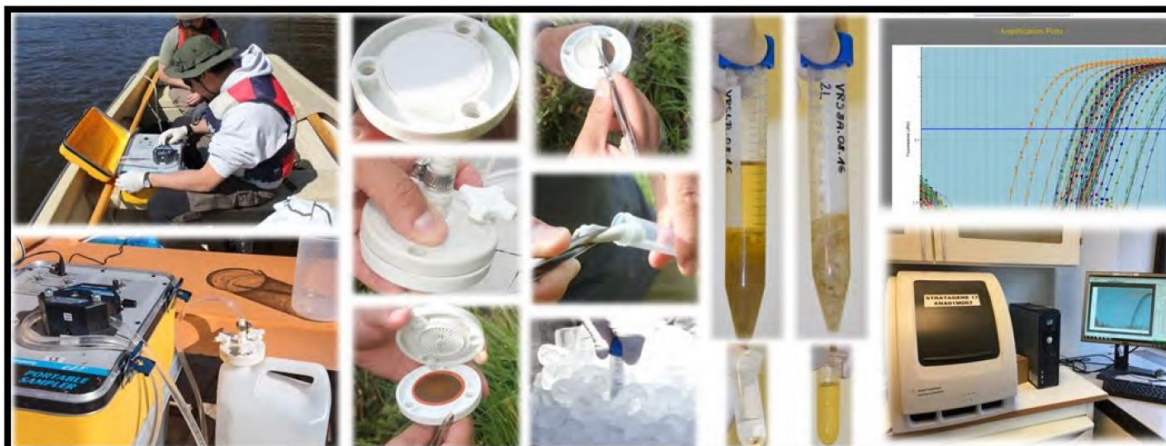
Figur 4.2. Vannprøver på ~5 liter ble filtrert på stedet ved hjelp av en portabel peristaltisk pumpe. Filterene ble overført til falcon-rør og oppbevart på is før lagring på frys. DNA ble isolert med en CTAB ekstraksjonsmetode og tilstedeværelsen av eDNA fra edelkreps og signalkreps ble undersøkt med qPCR.
